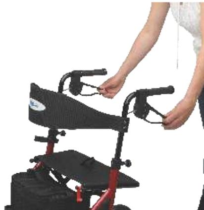
**Feststellbremse (beim Parken):** Drücken Sie den Bremshebel nach unten. Die Bremse ist korrekt eingestellt, wenn die Bremshebel wie auch die Bowdenzüge kein Spiel aufweisen und die Räder sich, bei gelöster Bremse ohne Schleifgeräusche drehen lassen.
